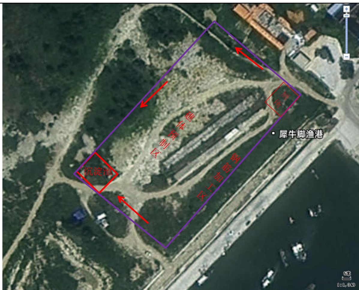
图 4-2 礁体预制场地布置及初期雨水收集示意图
