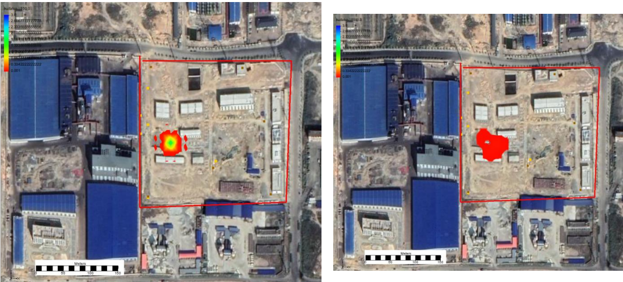
第 100 天污染羽分布（0.02mg/L~0.6mg/L） 第 1000 天污染羽分布（0.02mg/L~0.6mg/L） 图 4.4-9 生产期非正常工况挥发酚预测结果
