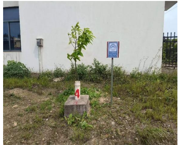
现有地下水监控井
